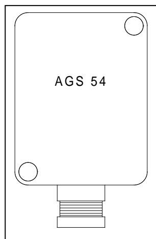
obr 2: Montážní poloha venkovního čidla
